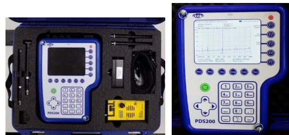
Photos 12a and 12b. Doble PDS-200 EMI Surveyor.
