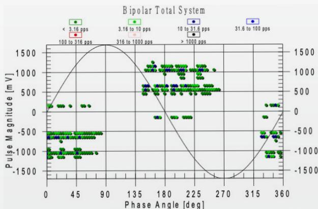
PHASE RESOLVED PARTIAL DISCHARGE PLOT SHOWING POSITIVE AND NEGATIVE PULSE MAGNITUDES (mV) AND PULSE COUNT (PULSES PER SECOND) AGAINST PHASE ANGLE OF AC CYCLE FOR SYSTEM DISTURBANCE
