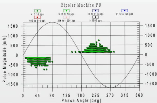
PHASE RESOLVED PARTIAL DISCHARGE PLOT SHOWING POSITIVE AND NEGATIVE PULSE MAGNITUDES (mV) AND PULSE COUNT (PULSES PER SECOND) AGAINST PHASE ANGLE OF AC CYCLE FOR MACHINE PD
